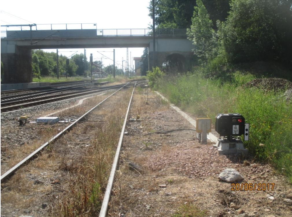
**Bild 1:** Gleis 864 mit Gleissperre (Blickrichtung Fröttstädt)
